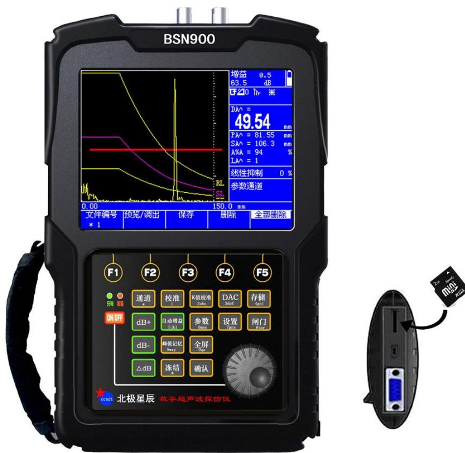
**概述：** BSN900 超声波探伤仪内置焊缝、铸锻件等探伤工艺，调出即可探伤。能够快速便捷、无损伤、精确地进行工件内部多种缺陷（裂纹、夹杂、气孔等）的检测、定位、评估和诊断。广泛应用于汽车、钢结构、压力容器、电力、石化、压力管道、冶金、军工航天、铁路交通、机械、高校等领域。
